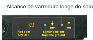
O alcance de varredura totaliza 7 níveis, pressione o botão uma vez, um bipe de voz, o alcance de varredura aumenta ou diminui cerca de 5 cm, se você ouvir dois bipes de voz, significa que o alcance de varredura está no limite.
